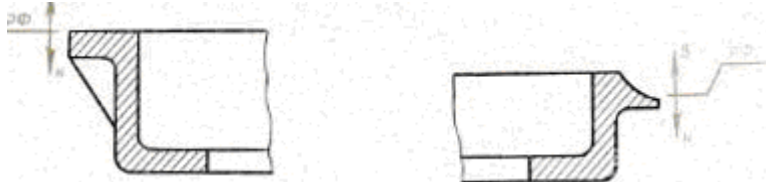
Рис. 8.2. Обозначение разъемов модели и формы для неразъемной модели
